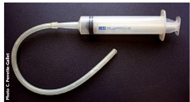
Figure 69 : seringue équipée d'un tuyau souple pour les prélèvements dans les anfractuosités de roche ou de corail. Syringe with flexible pipe to catch biological material in cavities of rocks or corals.
